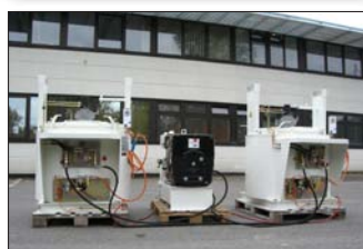
④ Dva kotle D350 s plynovým hořákem, 10 kW generátor
