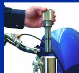
Vysokotlaký filtr: účinná filtrace, snadná údržba
